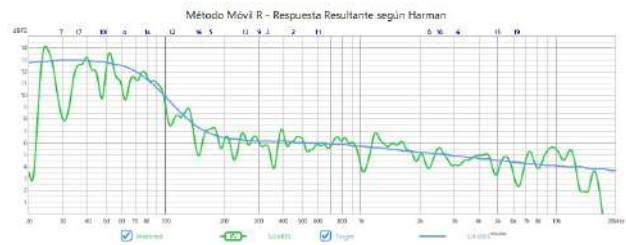
(b) Respuesta en frecuencia obtenida según ISO-16283 al aplicar los filtros basados en la curva de Harman; monitor derecho (R).
