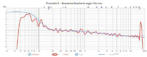
(b) Respuesta en frecuencia resultante de aplicar los filtros basados en la curva de Harman, para el promedio de las posiciones, monitor derecho (R).
