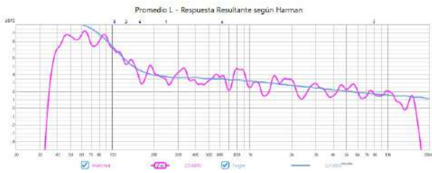
(a) Respuesta en frecuencia resultante de aplicar los filtros basados en la curva de Harman, para el promedio de las posiciones, monitor izquierdo (L).
