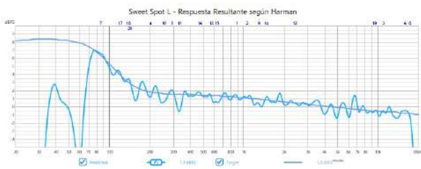
(a) Respuesta en frecuencia resultante en el Sweet Spot al aplicar los filtros basados en la curva de Harman; monitor izquierdo (L).
