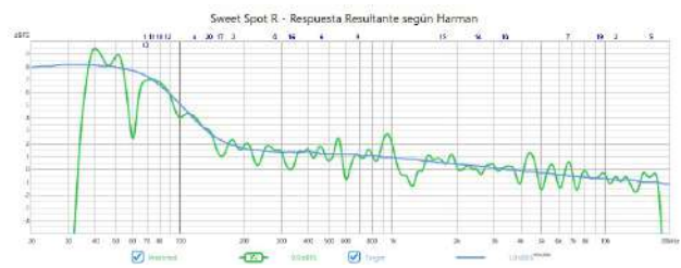
(b) Respuesta en frecuencia resultante en el Sweet Spot al aplicar los filtros basados en la curva de Harman; monitor derecho (R).
