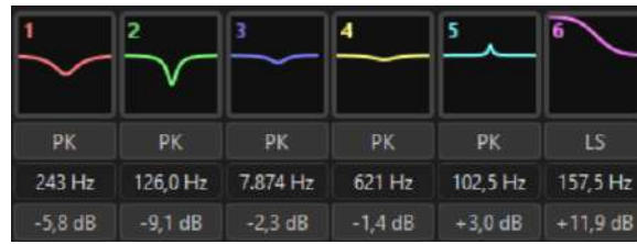
Figura 20: Filtros aplicados a la respuesta promedio para el monitor izquierdo (L), basados en la curva de Harman.
