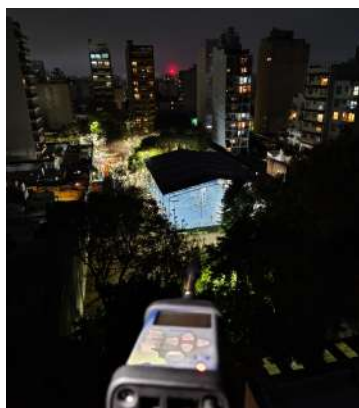
(e) Detalle del sonómetro apuntando a la cancha.
